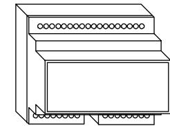
Carte d'interface pour commande jusqu'à 4 ventilo-conveuteurs. Montage à bord de l'unité.
