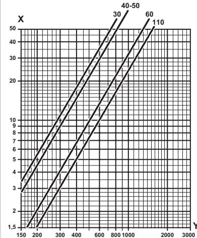
La perte de charge se réfère à une température moyenne de l'eau de 10°C; pour des températures moyennes différentes, multiplier la perte de charge par le coefficient K reporté sur le tableau.
