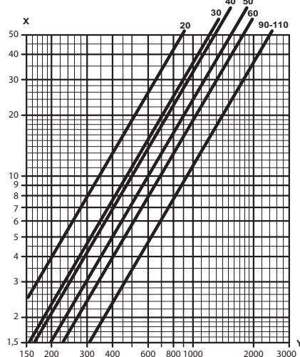
La perte de charge se réfère à une température moyenne de l'eau de 10°C; pour des températures moyennes différentes, multiplier la perte de charge par le coefficient K reporté sur le tableau.
